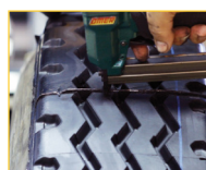
Ricopertura pneumatici Tyre retreading
